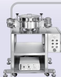
S20、25、30U型は直下排出型のスクリーンと枠が一体になっている中心部に直接、共振子を取り付けて、スクリーン全体に超音波を伝える構造になっています。直下排出型はモーターが本体外部で静音性に優れ、排出効率が良いので小型モデルに適しています。
