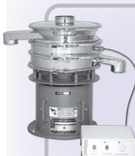
CB40U型はカセット型のスクリーンと枠が、一体になった特性を生かして、その枠に共振リングを取り付け、スクリーン全体に超音波を伝える構造になっています。小型ながらウルトラソニックSGモデルと同様の構造です。
